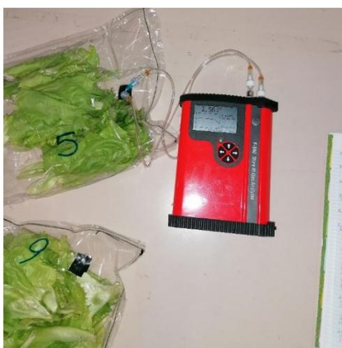
**Figura 5.** - Determinazione della composizione dell'atmosfera interna.
